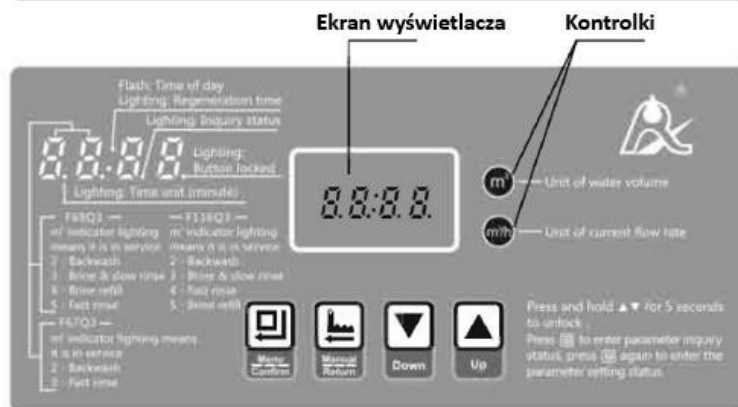
Rysunek 5 Wygląd panelu przedniego w wybranych głowicach serii Q1 i Q3.
