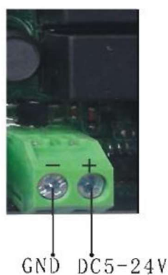
Rysunek 8 Złącze do zdalnej obsługi (PC) w powiększeniu.
