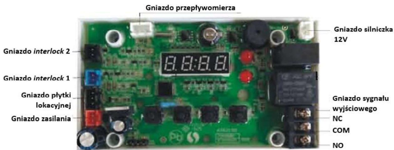
Rysunek 7. Wygląd płytki sterującej z głowicy sterującej serii Q.
