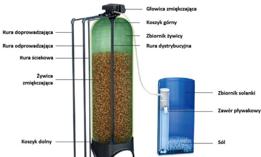
Rysunek 4 Kompletny system zmiękczający podłączony do instalacji wodociągowej.
