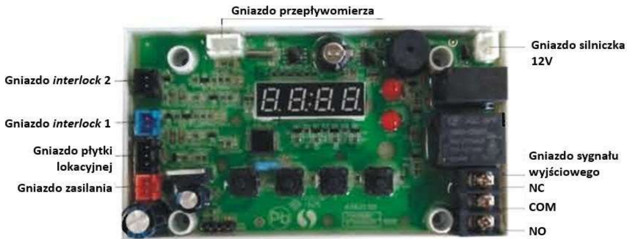
Rysunek 6. Wygląd płytki sterującej z głowicy sterującej serii Q.
